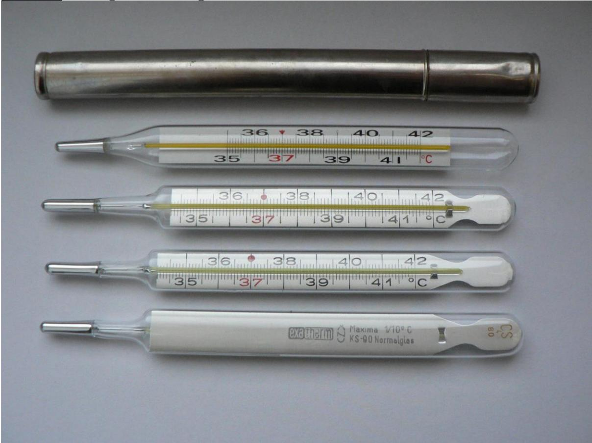
Inventé en 1724 par le physicien allemand Daniel Gabriel Fahrenheit, il fonctionne avec un tube de verre contenant du mercure, un élément chimique à l'apparence liquide dont la longueur dépend de la température. Pour mesurer cette dernière, le tube de verre est nécessairement gradué en températures. À ses extrémités, le tube du thermomètre est formé d'une ampoule pour l'une, elle aussi remplie de mercure, et d'un composé d'azote pour l'autre.
